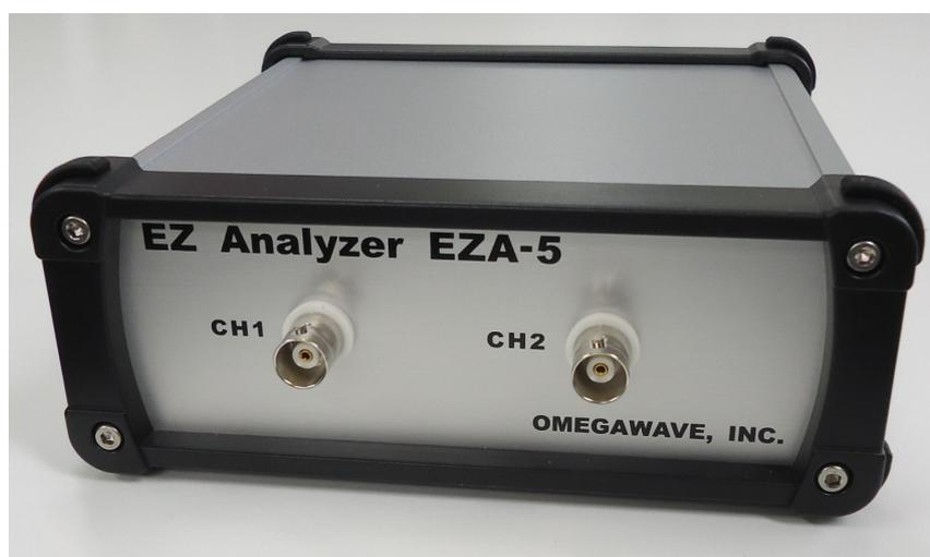
概要： EZ Analyzer(イージーアナライザー)はコンピュータベースの、アナログ信号の周波数解析が簡単にできる機器です。
