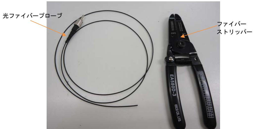
図 26. 光ファイバプローブとワイヤーストリッパー
