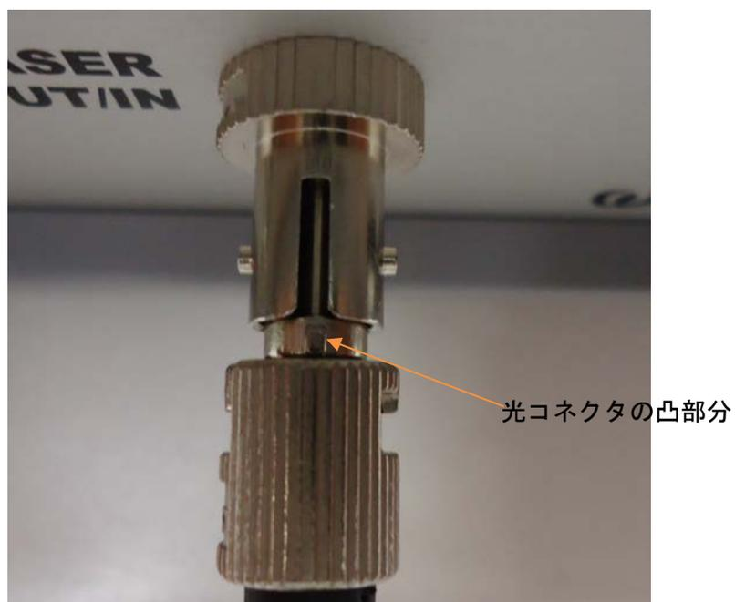
図6. 光ファイバプロープのコネクタの差し込み
