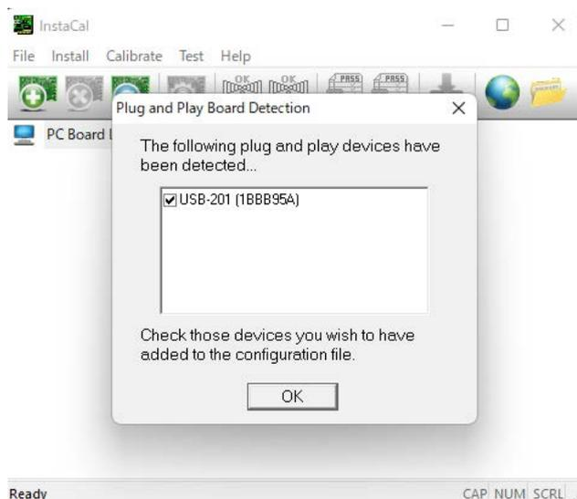
図25. Instacal32による新しいA/Dコンバータの認識
