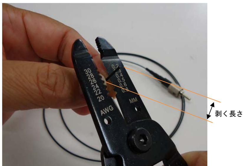
図 27. ファイバーストリッパーの溝に光ファイバプローブをセット
