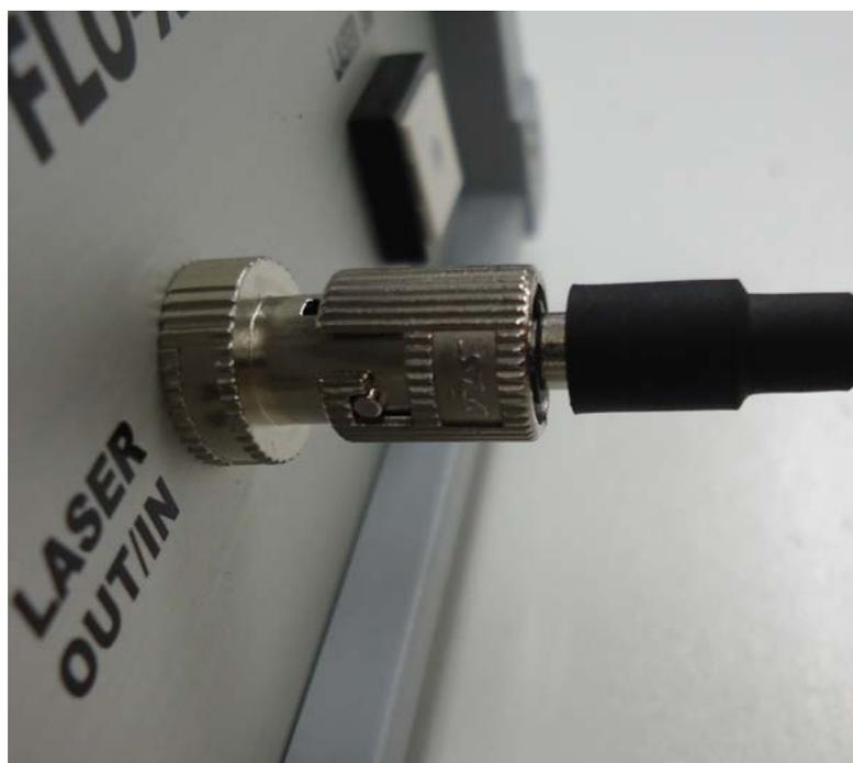
図8. 光コネクタが光アダプタに固定して接続された状態
